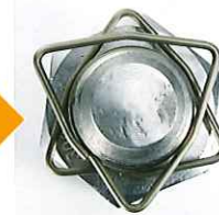
ボルトにペタルファスナーを装着 外形が三角形から六角形に変位。 ネジ部に緊張力が発生し、ナットの 脱落を防止します。
