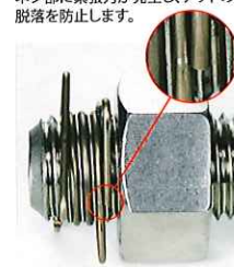
右側が施工完了。 ナット側の末端がナットと接触し拡径されナットと平行となり、 スプリング3辺でナットに対する押圧が発生している状態。
